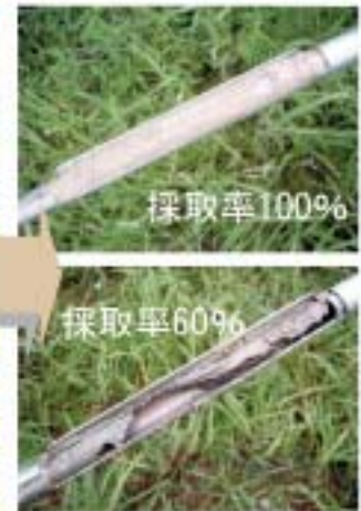
④サンプラーを引き上げコアを観察する。
